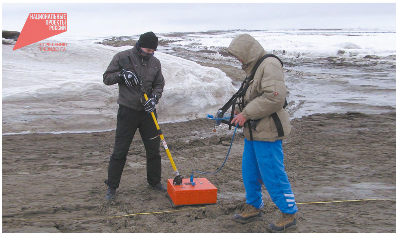
Георадарное обследование газопровода на Ямале. Фото А. Вдовиной
