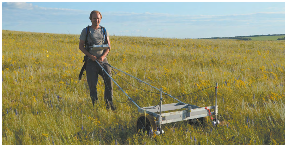
Картирование древних курганов с помощью магнитометрии. Фото Л. Муравьевой
